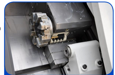
TORRE HIDRÁULICA 8 POSIÇÕES
