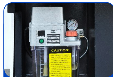
BOMBA DE LUBRIFICAÇÃO
