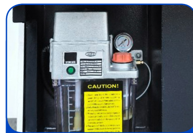
BOMBA DE LUBRIFICAÇÃO
